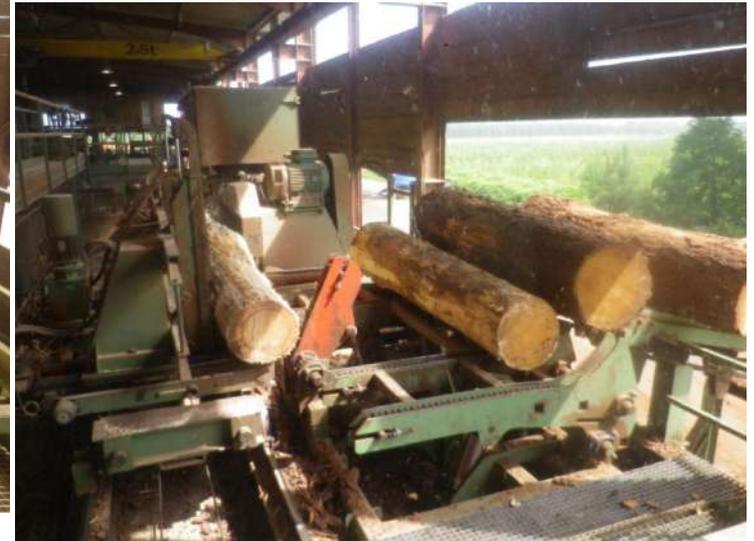
**Insertion en parallèle de la ligne canter Linck d'un ruban à grumes en 2016 et connexion par chaînes avec le canter.**
