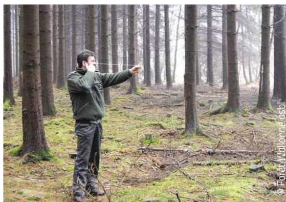
Mesure de la surface terrière avec un relascope à encoches (Beauraing).
